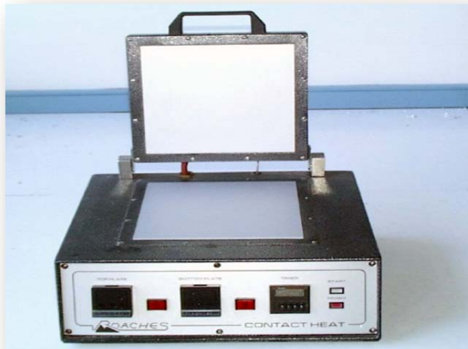
Roaches contact heat – aparat za določanje barvnih obstojnosti na vroče likanje
