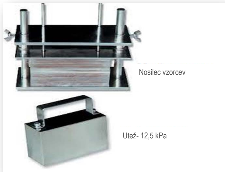
Pripomoček za določanje obstojnosti barve na kisli in alkalni znoj
