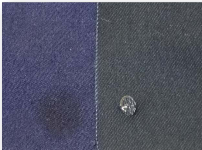
Na olje ne-odbojen tekstilni material (levo) in na delovanje olja odporen tekstilni material (desno)
